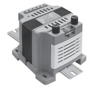
FUSED TRANSFORMER는 1차 측에 Fuse를 장착하여 제작된것으로 부하 단락 및 과부하시 TRANSFORMER 보호 및 설비의 안전 사고를 미연에 방지할 수 있 습니다. 또한 DIN Rail 및 Bolt 취부 겸용으로 DIN Rail 사용시 손쉽게 장착 할 수 있습니다.
