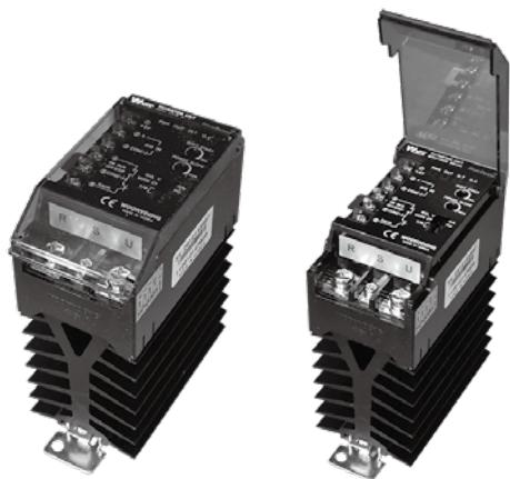
MICOM 회로를 채택하여 제어부분의 기능을 보다 정밀화 하였고 위상제어 및 사이클 제어가 결합으로 한 제품에 내장되어 있어 현장에서의 설정 및 설치가 쉬우며 AC 110~220V 전원 LINE의 25A와 40A의 부하 전류를 제어할 수 있고 Soft Start 기능이 설정 가능하여 부하의 소손 및 수명에 대한 신뢰를 높였습니다.
