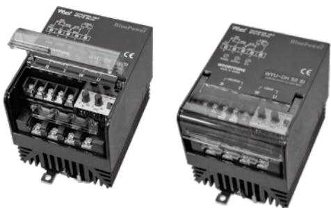
위상제어 및 사이클 제어가 겸용으로 한 제품에 내장되어 있어 현장에서의 설정 및 설치가 쉬우며 AC220V, 380/440V와 25~50A의 부하 전류를 제어할 수 있고 Soft Start 기능이 설정 가능하여 부하의 소손 및 수명에 대한 신뢰를 높였습니다.
