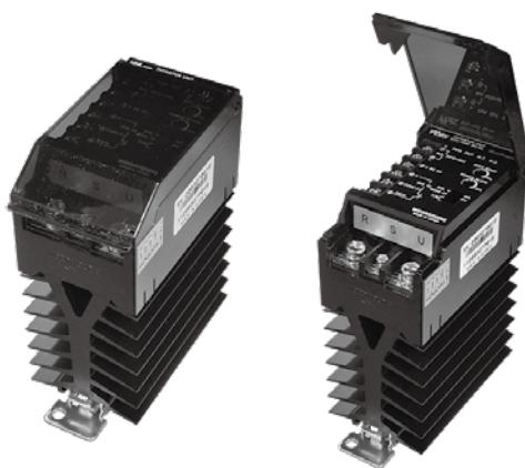
MICOM 회로를 채택하여 제어부분의 기능을 보다 정밀화 하였고 위상제어 및 사이클 제어가 결합으로 한 제품에 내장되어 있어 현장에서의 설정 및 설치가 쉬우며 AC 380~440V 전원 LINE의 25A와 40A의 부하 전류를 제어할 수 있고 Soft Start 기능이 설정 가능하여 부하의 소손 및 수명에 대한 신뢰를 높였습니다.
