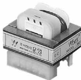
단상 복권형으로 입력전압은 AC110/220V 이고 출력측은 중간 Tap 방식이며 Printed - Circuit용 (P.C.B)으로 제작 되었으며 1,2차간 권선분리형 으로 1, 2차 절연이 확보되어 안전성 및 Noise에 영향이 없도록 제작 되었습니다.
