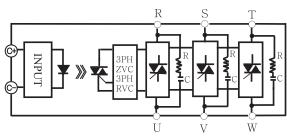
\* 3PH ZVC : 3PH ZERO CROSS VOLTAGE CIRCUIT \* 3PH RVC : 3PH RANDOM CROSS VOLTAGE CIRCUIT
