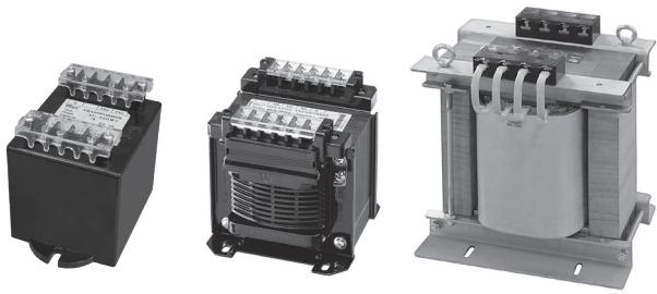
단상단권형으로 입력과 출력 전압이 한권선으로 전압탭을 인출하여 크기가 작고 가격이 저렴한 반면 사용이 제한되어 Lamp, Heater, Motor, Fan부하 등 단순 부하에 사용되거나 콘트롤을 제어 위치제어 PLC, 각종 Noise에 영향을 받는 제품 사용시에는 오동작 우려가 있으니 신중하게 고려 하시기 바랍니다.
